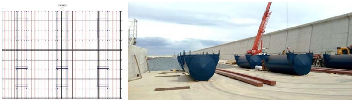
*Figura 45. Ejemplo de esquema de 6 flotadores para una batea Formex® Mixta*
