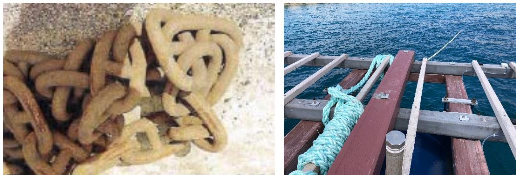
*Figura 60. Cadena de grilletes y ejemplo de collar de estacha de nylon*
