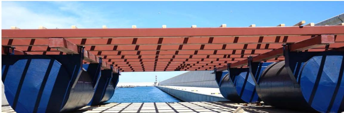
*Figura 55. Batea Formex® tras la instalación de los pontones*
