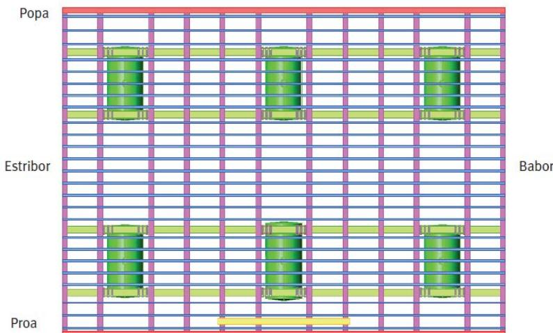
*Figura 46. Esquema de batea con maestras a través*
