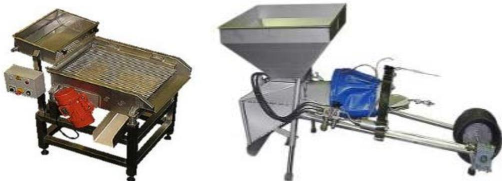
Figura 22. Izquierda: Clasificadora de mejillón mediante vibración Taller Dios (Illa de Arousa). Derecha: Encordadora (o desdobladora) con dos motores hidráulicos. Taller Dios (Illa de Arousa).
