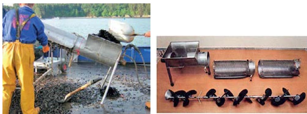
*Figura 15. Separación del mejillón de la cuerda y despiece de desgranadora*
