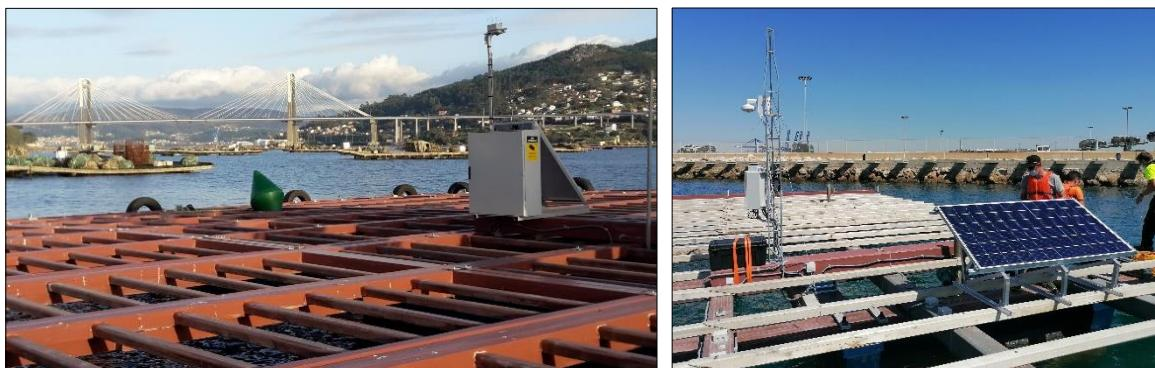
*Figure 39. Izquierda: Cámaras de video instaladas en las bateas del proyecto SELMUS-738777. Derecha: Segunda generación de cámaras de video de RDC. Desarrollada en el proyecto OpenMode*
